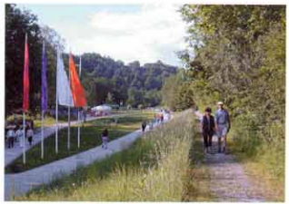
Die großzügigen Spazierwege aus wasserdurchlässigem Bitumenbelag mit sandgestrahlter Oberfläche sind Teil der Retentionsfläche.
